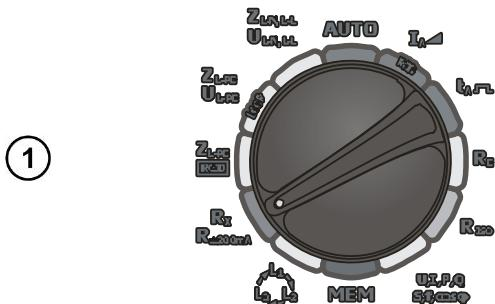
Установите поворотный переключатель в режим  $R_x$ ;  $R_{\pm 200mA}$ .
