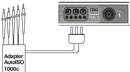
Измеритель MPI-520 автоматически определит подключение адаптера AutoISO-1000c и добавит необходимые возможности настройки.
