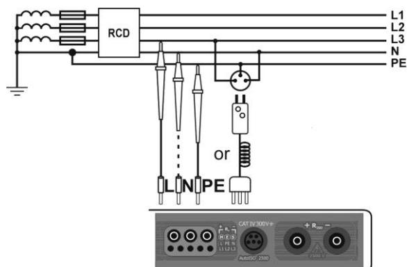
Подключите измеритель согласно схеме.
