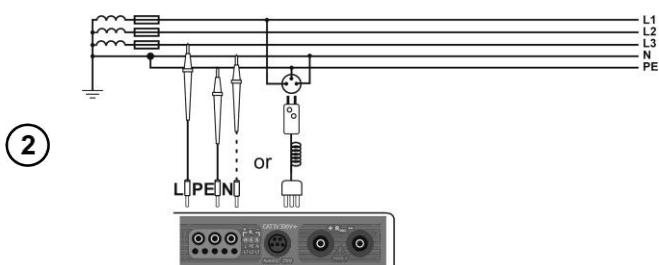
Подключите измеритель согласно схеме:
