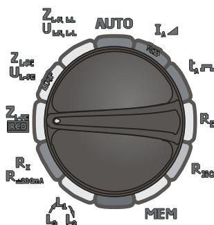
Установите поворотный переключатель в режим **Z<sub>L-PE</sub> RCD**.
