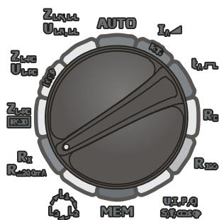
Установите поворотный переключатель в режим  $R_x$ ;  $R_{\pm 200\text{mA}}$ .
