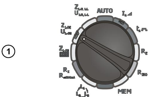
Установите поворотный переключатель в режим  $Z_{L-PE}/U_{L-PE}$ .
