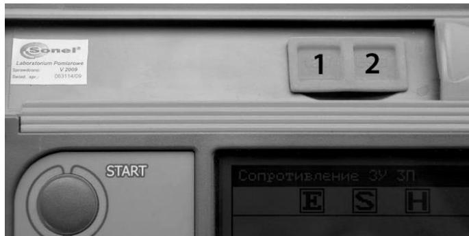
Расположение разъёмов зарядки (1) и порт подключения компьютера USB (2)
