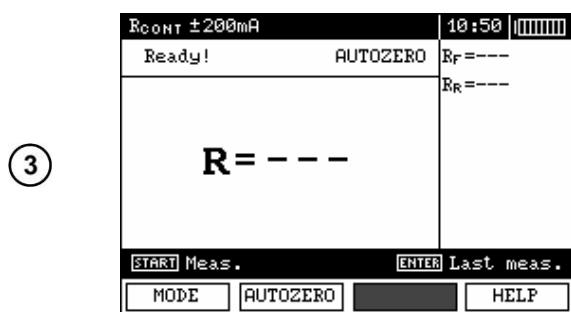
Для отмены **AUTOZERO** компенсации сопротивления (возврат к базовой калибровке), повторите описанный выше процесс, но в пункте 3 разомкните измерительные провода.
